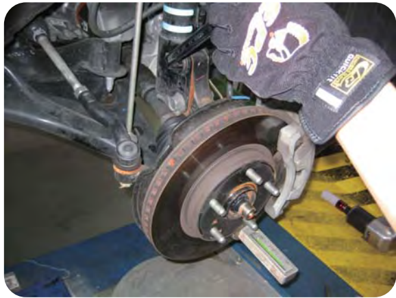
右フロントにEZカム取り付け、キャンバーを調整
