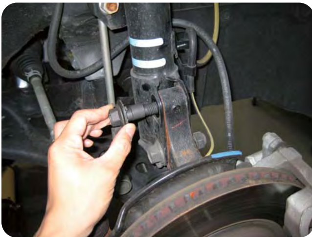
右フロントにEZカム取り付け、キャンバーを調整
