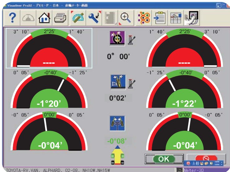
EZカムを取り付け、キャンバー調整後 (TOYOTAリアアシム取付後)
