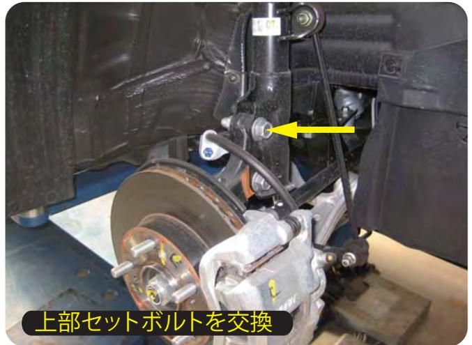
上側のセットボルトをキャンバーボルトに交換し、今回はネガティブ側(-)に調整するためアウタータブを車両内側に向けます。上側のボルトを交換し、この車両では片側のキャンバーが最大約1°40'変化しました。これに伴いフロントトーもトーインに約2°40'変化(約29mm)しました。
