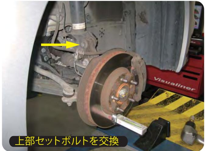
上側のセットボルトをキャンバーボルトに交換し、今回はネガティブ側(-)に調整するためラージタブを車両内側に向けます。上側のボルトを交換し、この車両では片側のキャンバーが約1°40'変化しました。これに伴いフロントトータルトーもトイン約3°まで変化しました。
