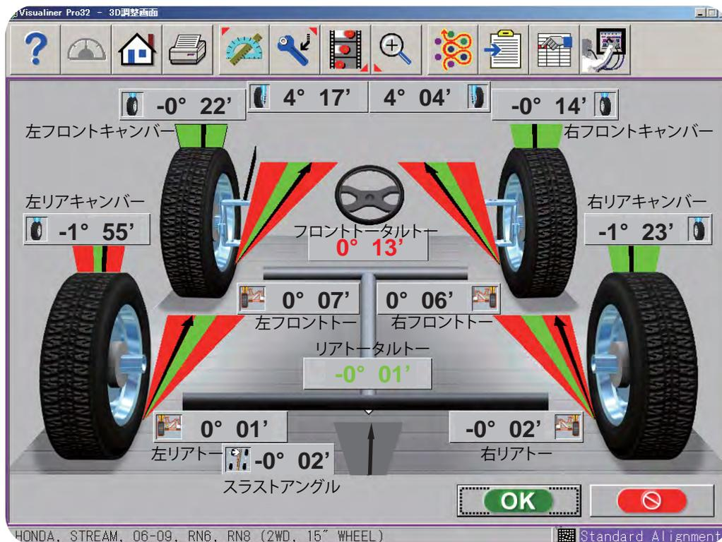
前後共にトーは調整機構が付いているため調整しますが、トーを調整する前にキャンバーボルトを取り付け、キャンバー値の変化量を確認します。
