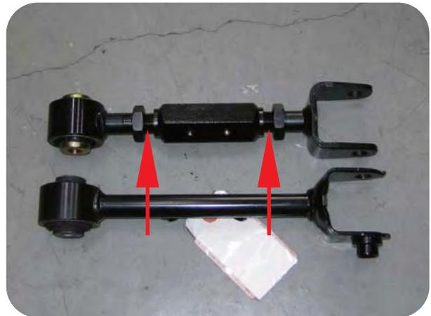
キャンバーアームを取り付け、サスペンションに荷重がかかっていることを確認して、規定トルクで締めつけます。(無荷重で締めつけるとブッシュ早期摩耗、異音の原因になります。)
