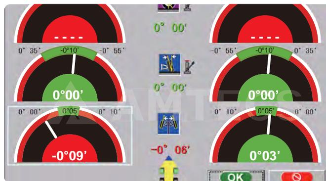
フロントキャンバーをポジティブ側に調整するとフロントトーがトーアウト方向に変化し、ネガティブ側へ調整するとトーインに変化するため、キャンバー調整後も必ずトー調整が必要になります。
