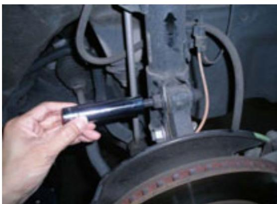
調整後、規定トルクに従って取り付けナット 2 個を締め付けます。
