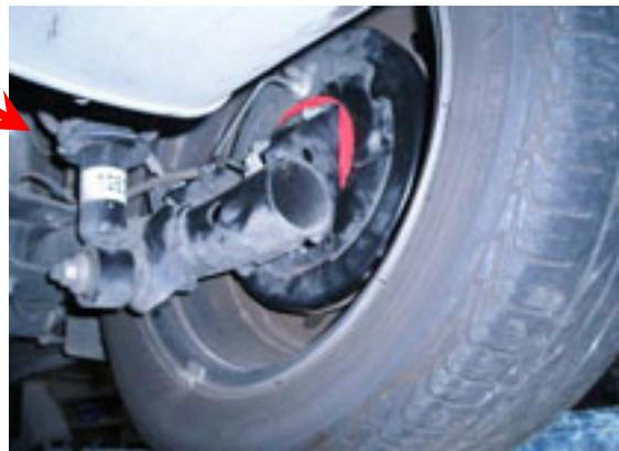
EZ シム レッドの内径が約 73mm、この車両のハブ径が約 74mm なので EZ シムの内側を約 1mm 削って拡げる必要があります。(NCP81G Sienta と同じ形状)
