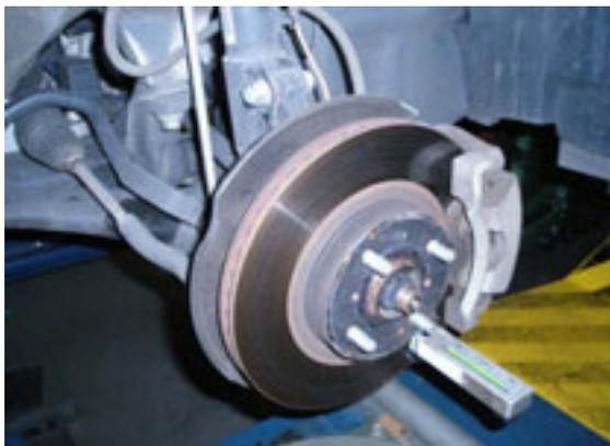
右フロントタイヤを外し、81139 マグネットキャンバーゲージをブレーキローターに取り付け、水準器の気泡をゼロに合わせます。
