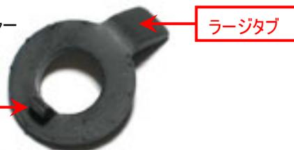
ロワー側のナットを緩め、水準器の気泡を見ながら EZ カムを回してキャンバーを調整します。
