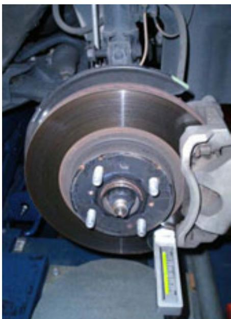
81270 EZ カム XR 1 本を、車両前方から挿入し、今回は右フロントキャンバーをネガティブ方向に調整するのでラージタブは車両内側に向けます。
