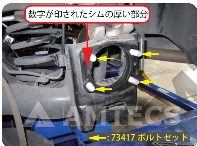
左リア $-0^{\circ}20'$ を変化量 $0^{\circ}12'$ のリアシムを取り付けて、 $0^{\circ}8'$ を目標に取り付けます。トーアウトに調整するためにシムの厚い部分を車両前方に向けて取り付けます。リアシム上の数字が印された部分がそのリアトーシムの一番厚い部分になります。
