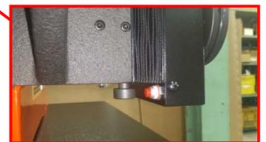
リミットスイッチ - ディスクロータの研磨が終わると自動的にモーターが停止します。研磨作業をずっと監視する必要はありません。セッティングを終えたら、研磨以外の仕事ができます。
