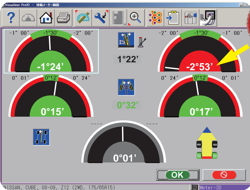
EZシムを取り付け、右リアキャンバー調整後
