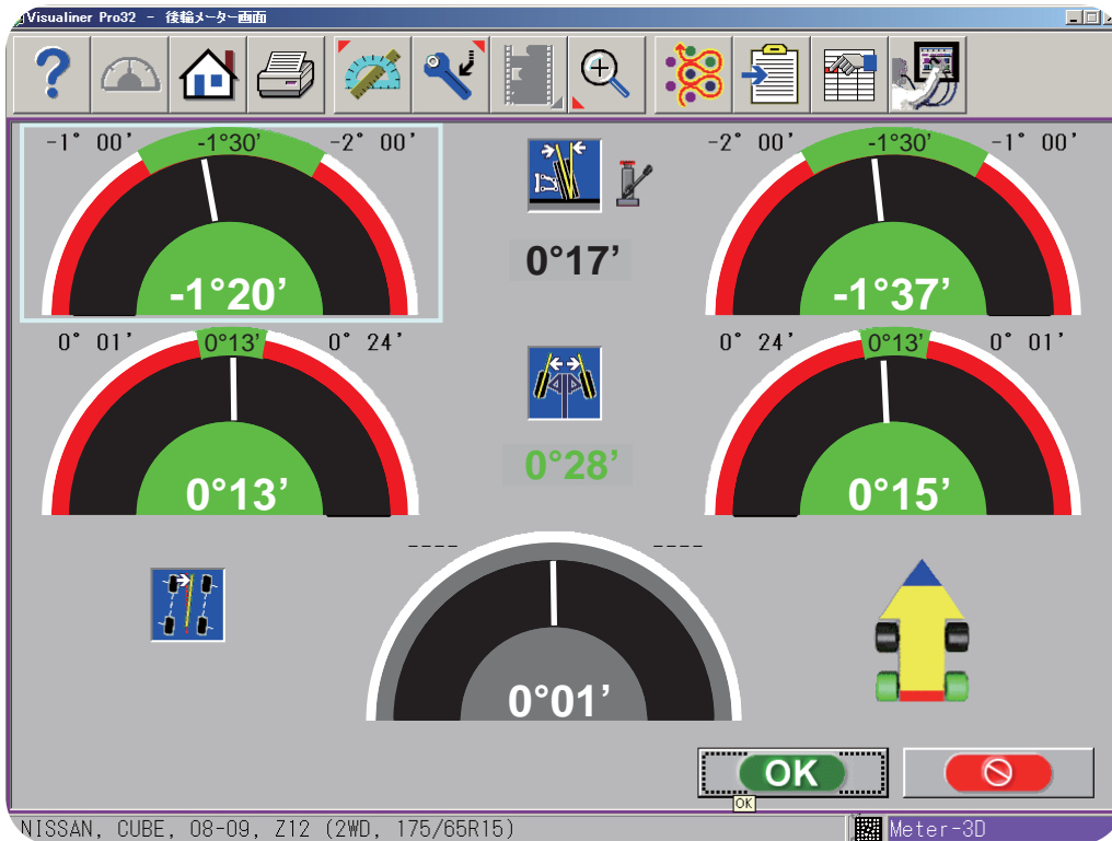
EZシムを取り付け、右リアキャンバー調整後
