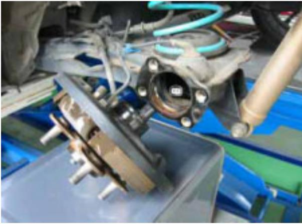
ミラ アヴィのバックプレートは突出した部分があり、ボルト穴部分は通常通り内側から切り、さらに突出部分を削るか切ってしまうと EZ シムがバラバラになってしまうため、取り付けボルト部とバックプレート突出部をいっしょに削ります。
